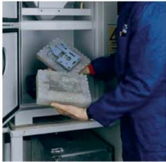
1. Metal Casting용 패턴 제작을 위하여 왁스모델을 진공주형기에서 제작
